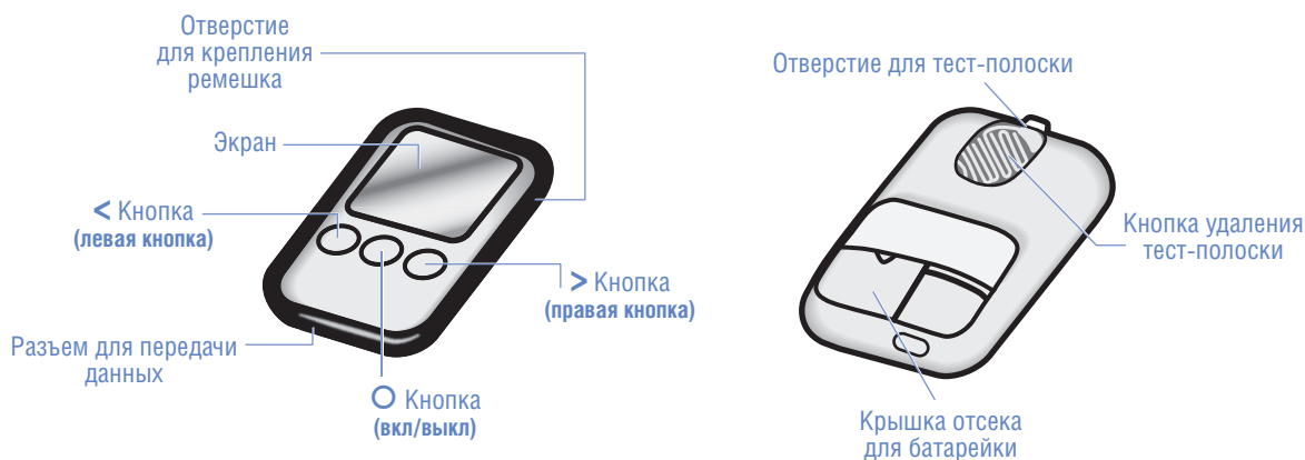
Схематическое изображение глюкометра ARKRAY – ГЛЮКОКАРД W
